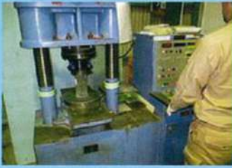
【標準供試体及びコア供試体の強度試験】
