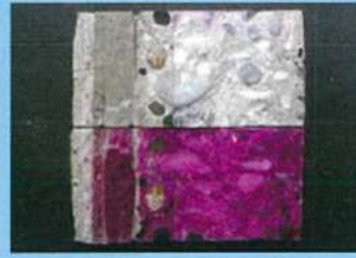
【コンクリートの中性化深さ測定】
