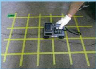
【電磁誘導法・電磁波レーダ法によるかぶり厚さ測定・配筋調査】
