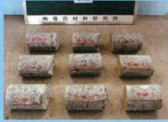
【標準供試体及びコア供試体の強度試験】
